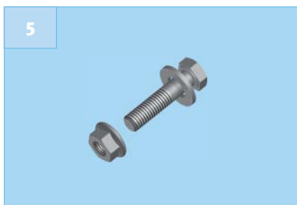
Sechskantschraube M8 mit Sperrzahnmutter und Scheibe
