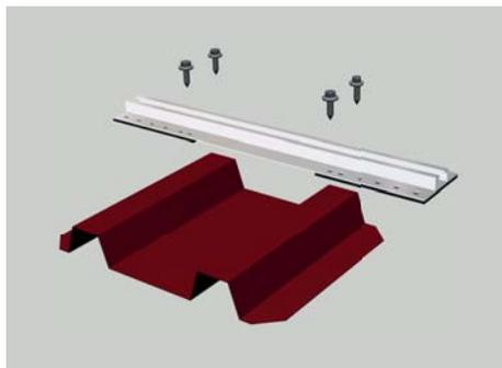
Die Profilschiene wird auf die Sicken aufgelegt, ausgerichtet und auf dem Trapezblech verschraubt.
